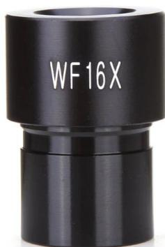
**WF16X** широкоформатный (диаметр поля зрения  $\Phi$ 11 мм; фокусное расстояние 15,6 мм, посадочный диаметр D23,2 мм). Может использоваться со всеми микроскопами с посадочным диаметром тубуса 23,2 мм. Высококачественные оптические элементы и цельнометаллический корпус. Может использоваться для металлографических, биологических и др. микроскопов.
