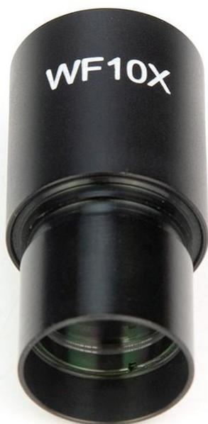
**WF-10X** микрометрический окуляр с перекрестием и измерительной шкалой с дискретностью 0,1 мм (диаметр поля зрения  $\Phi$ 17 мм, фокусное расстояние 25 мм, посадочный диаметр D23,2 мм). Может использоваться со всеми микроскопами с посадочным диаметром тубуса 23,2 мм. Высококачественные оптические элементы и прецизионная юстировка шкалы измерительной сетки с ценой деления 0,1 мм гарантируют максимально чёткое изображение и замер линейных размеров по всему полю зрения.
