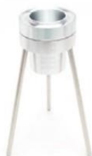
Штатив-тренога со встроенным уровнем и размещённым в нём вискозиметром
