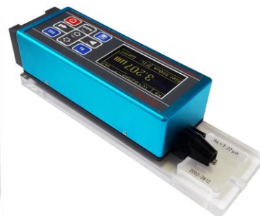
Рисунок 1 – Общий вид меры шероховатости поверхности в пластиковом прозрачном основании(а) и размещение меры в установочную рамку с выемкой и установка прибора для измерения шероховатости на рамке (б)
