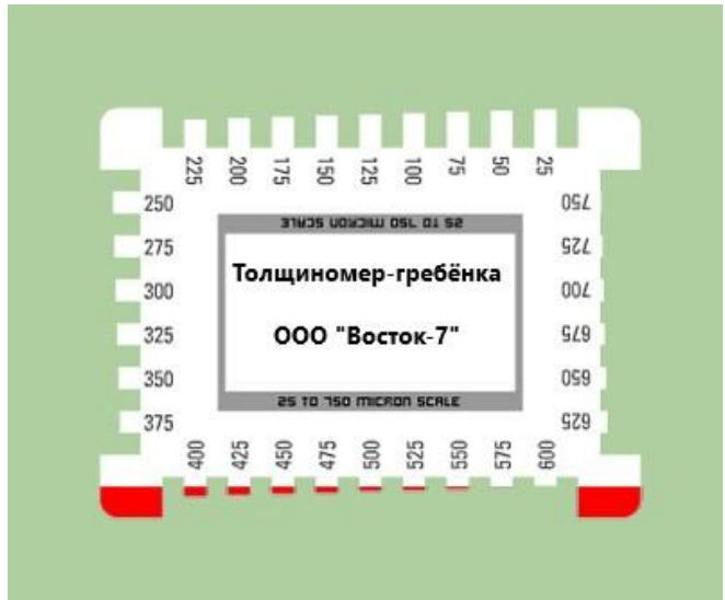
При измерении толщины второго слоя покрытия вдавливать гребёнку необходимо аккуратно, чтобы не повредить первый слой. При измерении толщины мокрого слоя на трубопроводе или аналогичной криволинейной поверхности, гребёнку следует размещать вдоль продольной оси. При измерении толщины мокрого слоя прозрачных красок, достаточно после измерения посыпать зубцы гребёнки тальком и сдуть излишки. Тальк останется только на «мокрых» зубцах.
