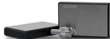
**Наконечник шариковый** к твердомеру для измерения твёрдости резин в международных единицах **IRHD** Ø: **2,5** мм.
