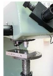
**Наконечник шариковый** к твердомеру для измерения твёрдости различных материалов: металлов, резин и пластмасс по методу **Роквелл** Ø: **1,588 / 3,175 / 6,35 / 12,7** мм по шкалам Роквелл В, F, G, E, H, K, M, L, R.
