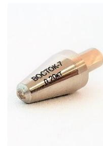
**Наконечник алмазный тип НПМ** с рабочей частью в виде четырёхгранной пирамиды с углом 136° к приборам для измерения микротвёрдости по методу Виккерса.
