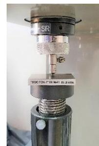
**Наконечник алмазный тип НП 1** с рабочей частью в виде четырёхгранной пирамиды с углом 136° к приборам для измерения твёрдости металлов по методу Виккерса.
