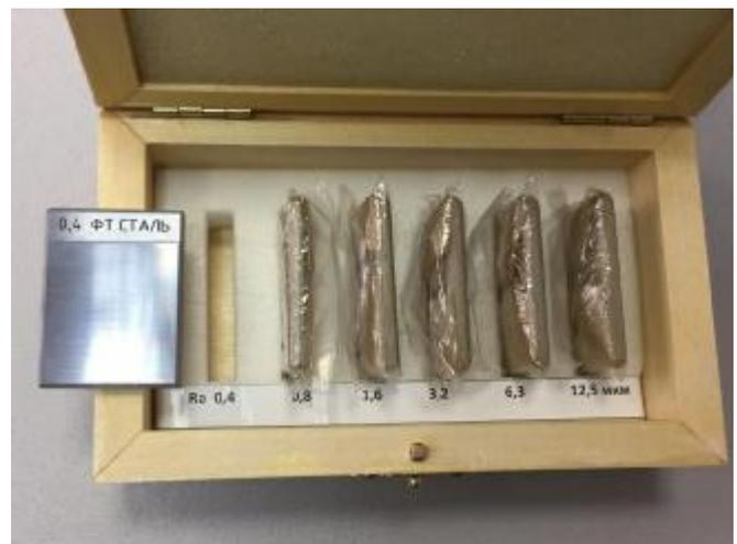
Рисунок 1 - Общий вид наборов образцов шероховатости поверхности (сравнения) модификации В7-1833
