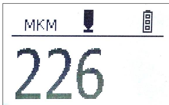
Рис. 2-2. Результат калибровки на образце 226 мкм
