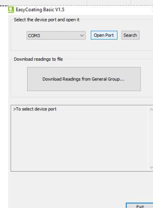
**Шаг 4.** Будет создана папка EasyCoating, выберите место на компьютере для её сохранения и нажмите кнопку Сохранить. Данные будут загружены на компьютер в формате блокнота \*.txt, где будет указан порядковый номер каждого измерения, значение измеренной толщины и указание размерности единицы измерений.
