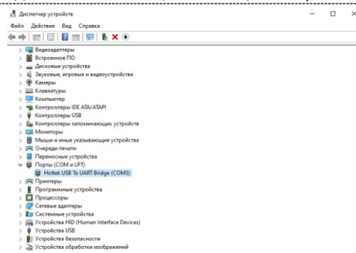
**Шаг 3.** Запустите установленную с диска на компьютер программу EasyCoating, выберите порт (в нашем примере COM3), подтвердите выбор и кликните на клавишу выгрузки данных.
