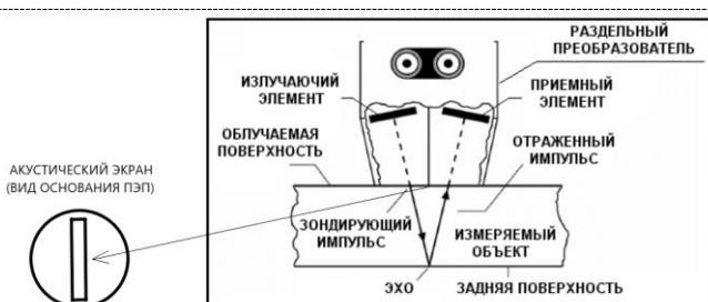
ПЭП – пьезоэлектрический преобразователь
