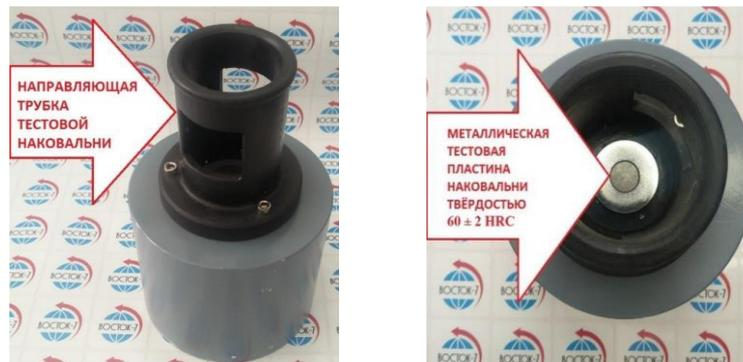
Наковальня состоит из стального цилиндра (определённой геометрии и твёрдости) и установленной на нём направляющей трубки. Снизу запрессована тестовая пластина из закалённой инструментальной стали.
